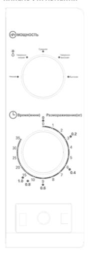
На панели управления расположены регулятор мощности работы микроволновой печи и регулятор времени приготовления/размораживания.
