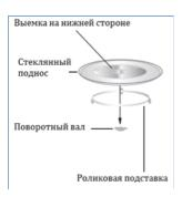
На поворотный вал устанавливается стеклянный поднос. Под стеклянный поднос устанавливается роликовая подставка, которая помогает подносу свободно вращаться. Вращение пищи во время работы печи способствует ее равномерному приготовлению.
