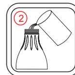
Залейте раствор в бак до желаемого уровня. Не превышайте максимально допустимый объем заливаемой жидкости (см. Технические характеристики опрыскивателя)
