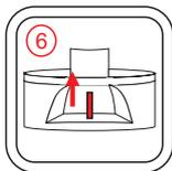
После завершения работы выпустите остаточное давление, потянув за шток предохранительного клапана, удерживая его до полного сброса давления
