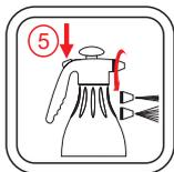
В начале работы настройте рассеивающую гайку, вращая ее вокруг своей оси (тип факела от струи до тумана). Для начала опрыскивания нажмите клавишу.
