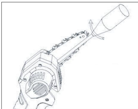
Рис. 4. Натяжение цепи болтом натяжителя
